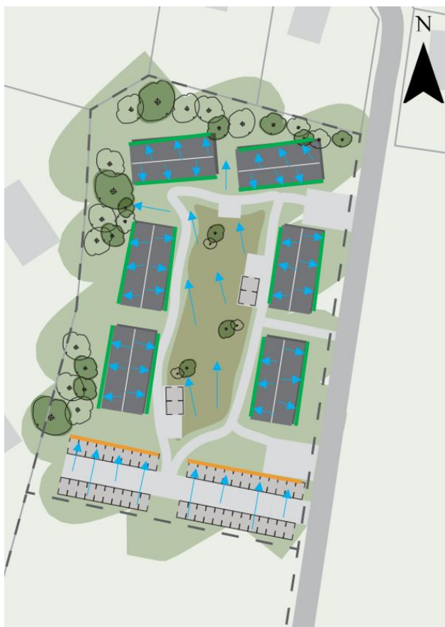
Figur 9. Situationsplan (Skellefteå kommun). Föreslagna LOD-åtgärder för utredningsområdet. Orange markering visar föreslagen placering av makadamdiken, grön markering visar föreslagen placering av regnbäddar. Flödespilar visar hur avrinningen av dagvatten ska nå till LOD-åtgärderna.
